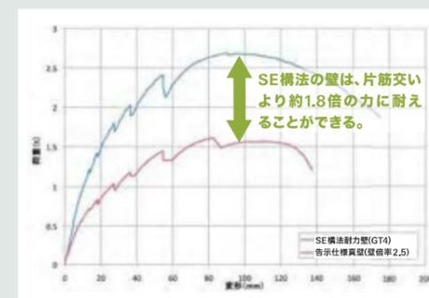
SE構法の壁は、片筋交いより約1.8倍の力に耐えることができる。
