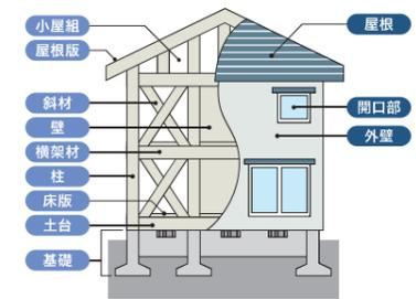
瑕疵担保責任期間10年義務づけの対象部分 (構造耐力上主要な部分および雨水の浸入を防止する部分イメージ)
