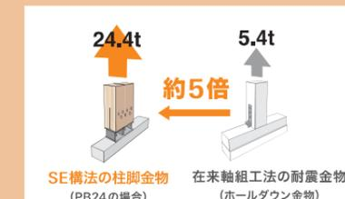
柱脚金物接合部強度実験
