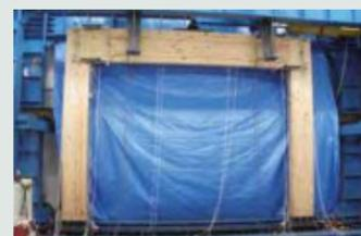
耐力フレーム水平加力実験
