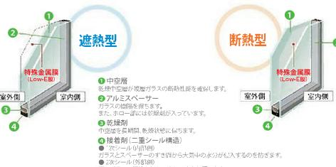
空気層16mm、総厚22mmガラスまで対応可能。さらに、一般複層ガラスの約1.5倍の断熱性能を発揮する高性能複層ガラスや、UVカット、防犯性に優れたタイプもご用意。使用場面や用途に応じてお選びいただけます。
